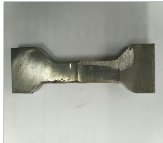
Fig. 2: Tensile Test Specimen.
